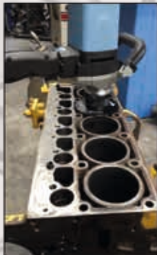
Werkzeugaufnahme mit 3 Wendschneidplatten
