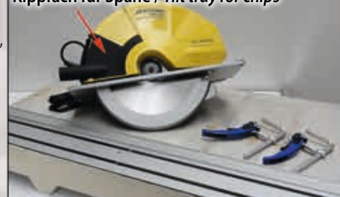
Kippfach für Späne / Tilt tray for chips
