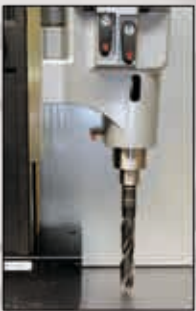
Vollbohren mit MK3-Adapter Twist drilling with MT3-adapter
