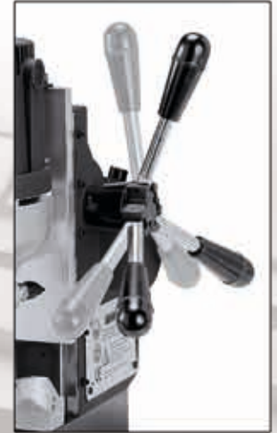
Der automatische Vorschub wird durch Umlegen des Kurbelhandgriffs aktiviert Automatic feed activation with crank handle
