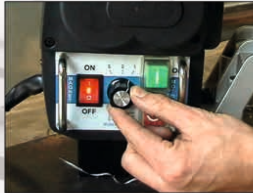
Automatischer Bohrbetrieb für Kernbohrer von Ø 14 - 30 mm Handbetrieb von Ø 12 - 35 mm Automatic drilling for core drills from Ø 14 to 30 mm Hand operation from Ø 12 to 35 mm
