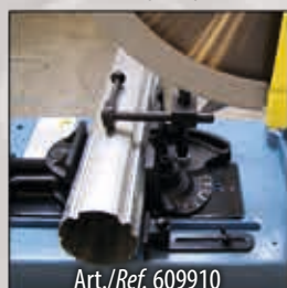
Art./Ref. 609910 exzentrisches Spannsystem eccentric clamping system
